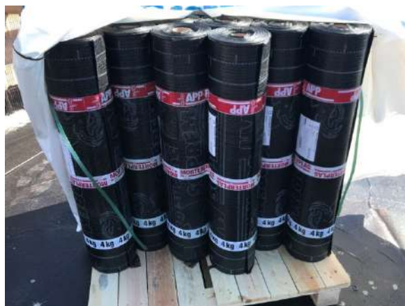
Emulsión asfáltica para imprimación de superficies y lámina de betún plastomérico.
